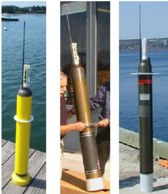
Photo 11 : Le type de bouée dérivante utilisé par le programme Argo
